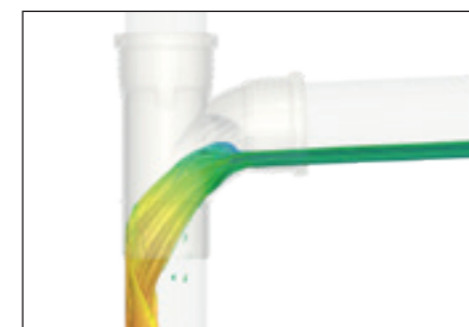
Med CFD (computational fluid dynamics) numerisk flowsimulering kan varianter testes virtuelt på forhånd...
