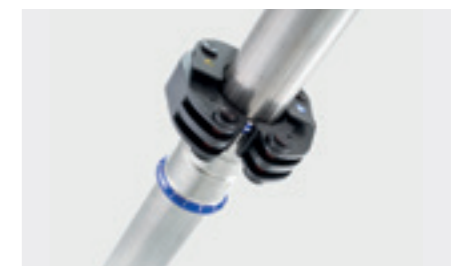
↑ Ab der Durchmesserdimension 63 mm bei Geberit Mepla und ab Durchmesser 42 mm bei Geberit Mapress kommen Pressschlingen zum Einsatz.
