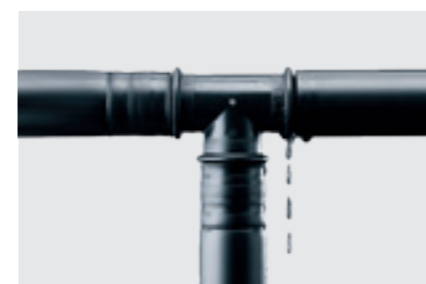
Definerede lækageveje gør upressede fittings synlige med det samme i trykprøvningen.
